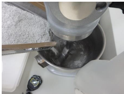
セメント材の投入
