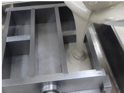
型枠への流し込み
