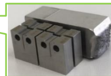
シャルピー試験片残材から の微小破壊靱性試験片加工
