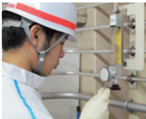
粉じんを捕集したろ紙の回収作業
