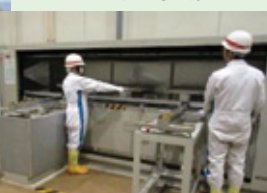
遠心機処理設備でウランを取り除き、放射能濃度を測定
