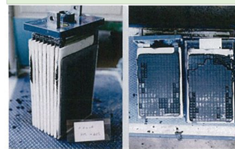
高経年化対策（無停電電源設備蓄電池の更新）
