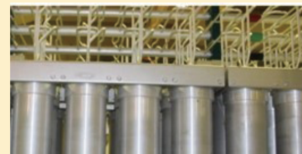
国の許可後に撤去予定の第2運転単位（OP-2）の遠心分離機
