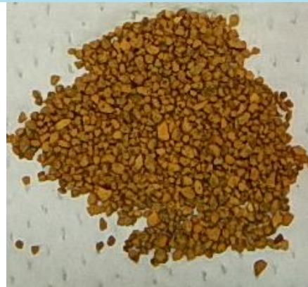
ろ過砂 (使用後)
