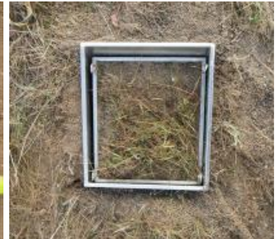
蒸発散計 (法面部)
