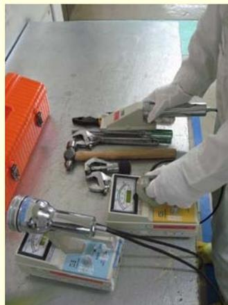
α線用サーベイメータによる物品表面密度測定
