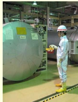
電離箱サーベイメータによる線量率測定
