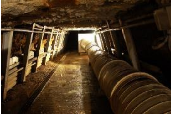
坑道内の様子（壁面の茶色部分がウラン鉱石）
