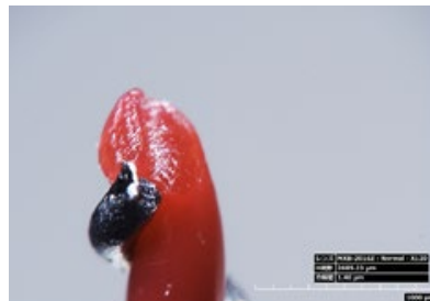
写真 8： NRA 封印ワイヤー切断面
