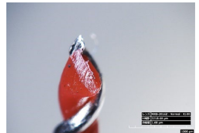
写真 9： 一般的なニッパでの切断面
