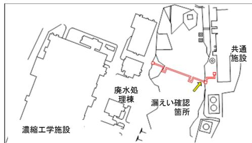
平成29年3月、共通施設から濃縮工学施設へ熱水を送る配管から蒸気の漏えいが発生しました。(一般区域であるため放射性物質を含む蒸気ではありません)
