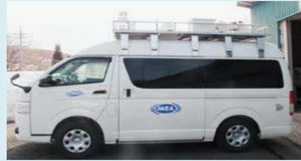
▲モニタリングカー 放射線測定機器等を搭載したモニタリングカーを配備しています。モニタリング車では、風向、風速、空間 \gamma 線線量率、大気中放射性物質濃度等が測定できます。
