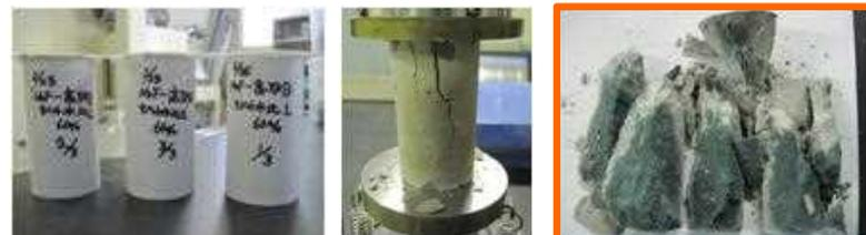
硬化後の強さを確認する試験のようす。
