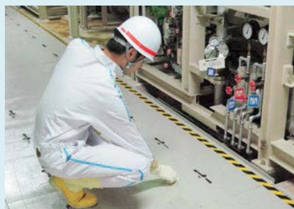
床面の汚染検査
