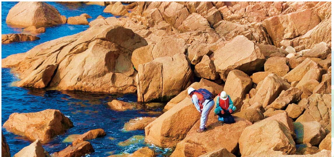
地表踏査の様子(現地を歩いて地表に現れている岩の割れ目、地形等を調査)
