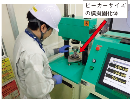
模擬固化体の圧縮強度の測定を実施する作業風景 (原子力機構の茨城県東海村にある核燃料サイクル工学研究所)
