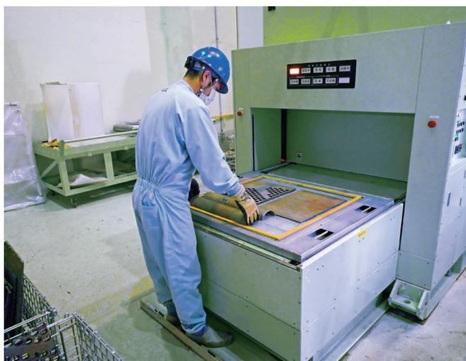
クリアランスモニタによる測定作業
