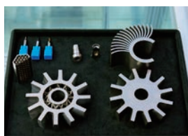
ハイブリッド金属3Dプリンタで製作した試作品。 複雑な形状のものや小さな造形も微細な部分まで滑らかに 仕上げている。
