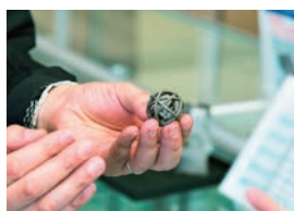
ハイブリッド金属3Dプリンタで製作した試作品。 複雑な形状のものや小さな造形も微細な部分まで滑らかに 仕上げている。
