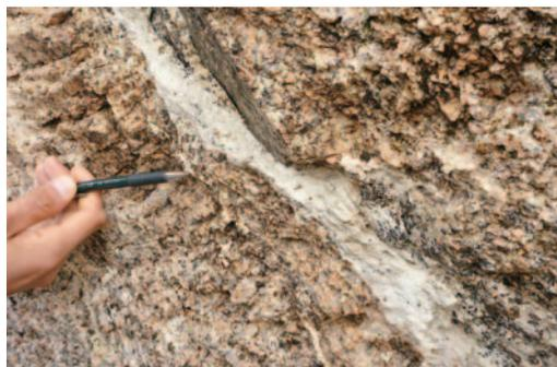
花崗岩中の破碎帯の粘土化した部分(白色部)の拡大写真(もんじゅ敷地内の破碎帯の例)
