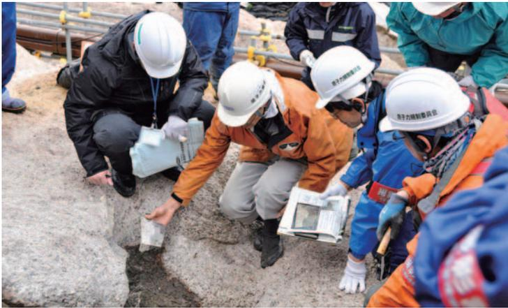
破碎帯沿いの試料の採取場所などを説明した剥ぎ取り現場
