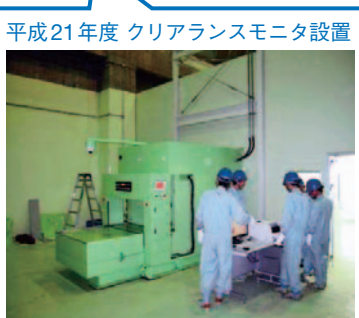
対象物の放射能濃度を測定・評価し、法に定める規準値以下であることを確認する
