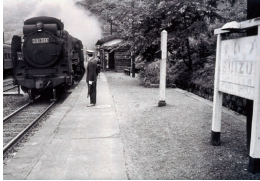
旧線で列車を牽引した蒸気機関車D51。電気式ディーゼル機関車DD50と三重連を組んで1000トン輸送を実現（今立 汎氏 撮影）
