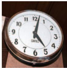
館内の古い時計はドイツ製。電動式で、親時計と各部屋の子時計が連動していた
