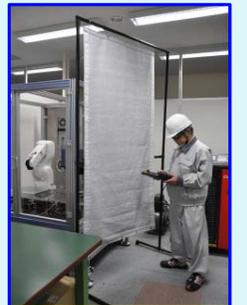
容易に設置でき、高出力のレーザーも外部に漏らさないレーザー遮光カーテン
