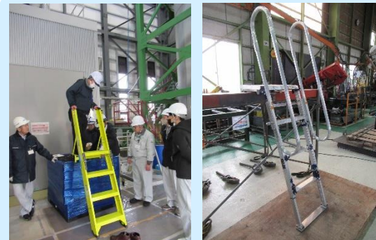
2024年度のテーマ「運搬及び安全性向上のための仮設昇降設備の検討・試作」の試作品
