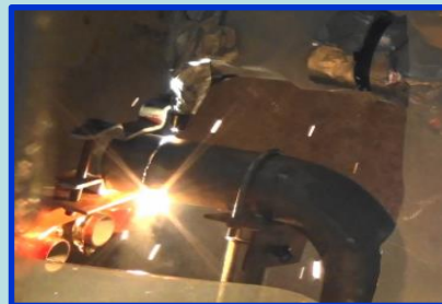
配管のレーザー切断試験
