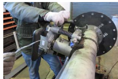
試作工具を使った試料採取の機能確認 (工具を配管に装着)
