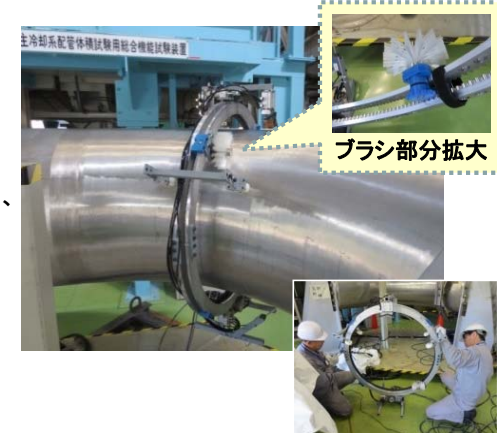
実物大配管模型を使った清掃装置の試験
