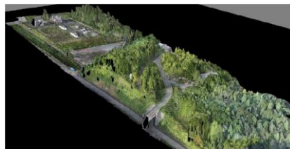
無人ヘリコプターが撮影したカメラ画像から作成した3次元画像
