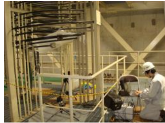
【モックアップ(模型)での伝熱管探傷試験】 (平成25年11月25日撮影)
