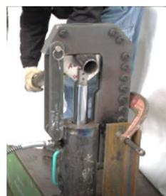
鋼管の無火気切断装置
