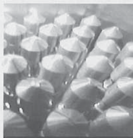
図4.2.1-3 ファイバースコープによるブランケット燃料集合体の燃料要素外観観察画像
