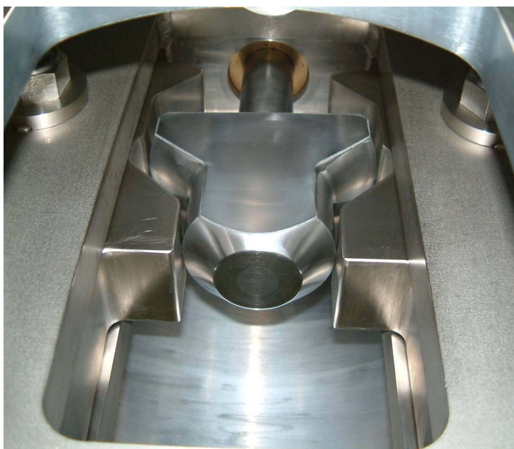
図 9.4.1-1(2) パワーシリンダ交換後の爪開閉ロッドの取付け状態
