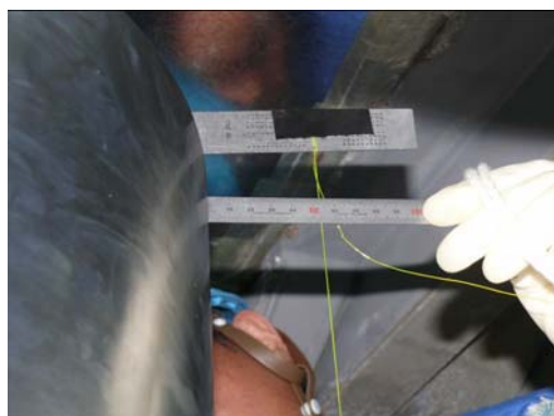
図 9.2.2(3)-15 寸法測定の様子(AHMグリッパ傾き量同定)
