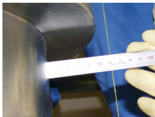
図 9.2.2(3)-15 寸法測定の様子(AHMグリッパ傾き量同定)
