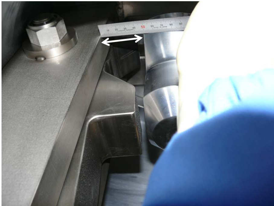
図 9.2.2(3)-10 寸法測定の様子(爪開閉ロッドの回転角度)
