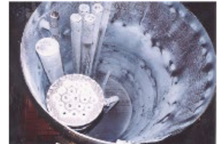
大洗での炭酸塩化処理後の機器内部のナトリウム炭酸塩の付着の様子
