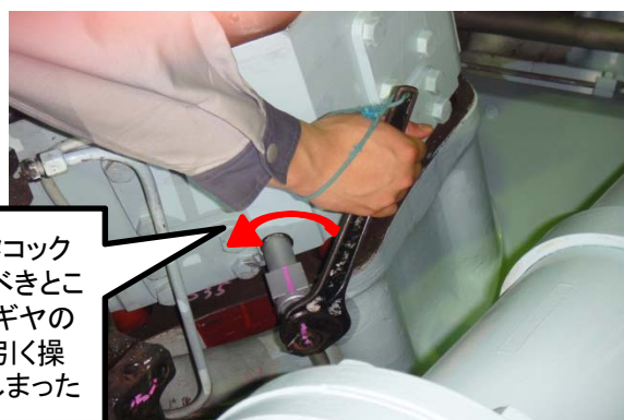
インジケータコック開操作写真
