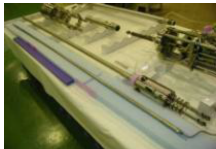
微調整棒駆動機構の分解点検状況
