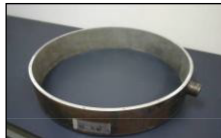
2次主冷却系配管(ステンレス鋼)
