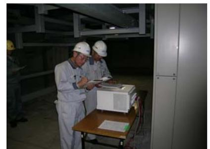
試験風景(切り替え時間測定用記録計の確認)
