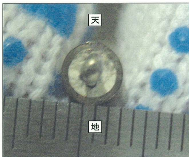
CLD先端部(芯線) (曲がり・変形等なく良好)
