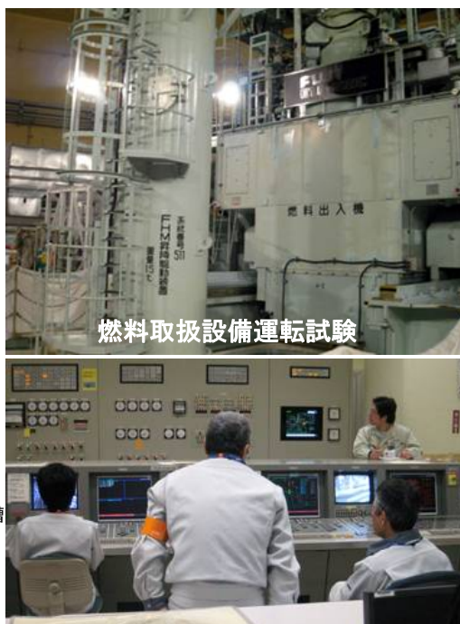
燃取系主制御監視盤からの自動運転風景
