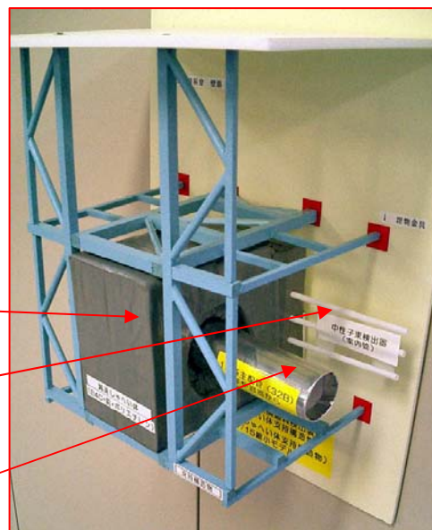
破損燃料検出装置の概略構造(模型)
