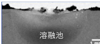
X線による溶融池生成観察 (SPRing-8)
