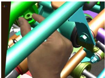
作業性の確認 （作業空間の確認）
