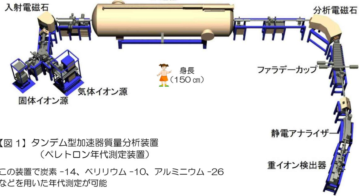
【図1】タンデム型加速器質量分析装置 (ペレトロン年代測定装置)
