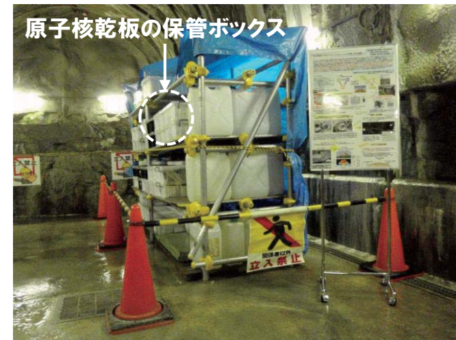
名古屋大学におけるニュートリノ 捕捉用原子核乾板の貯蔵 (深度200mボーリング横坑 主立坑)
