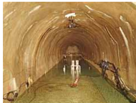
⑤止水壁前面の配管や水槽を設置した後、止水壁の機能確認試験を実施しました。右は、冠水坑道内で水が溜まる状況の写真です。
