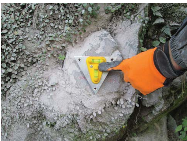
古地磁気測定用の定方位試料の採取
