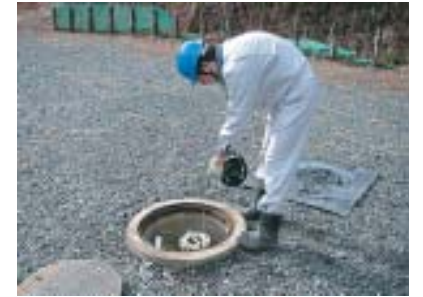
地下水の水位観測
