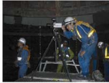
デジタルカメラ,赤外線サーモグラフィ 撮影状況
