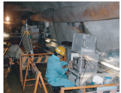
掘削音から地質構造を推定する調査
