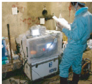
掘削音で地質構造を推定する調査
