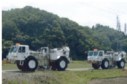
地震波を利用した物理探査
