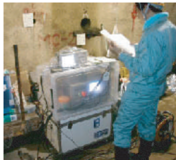
掘削音で地質構造を推定する調査
