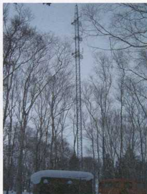
蒸発散量算定のための機器 (樹冠上蒸発散量観測システム)
