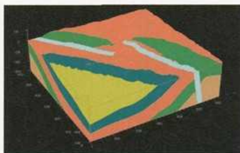
大曲断層を考慮した地質構造モデル
